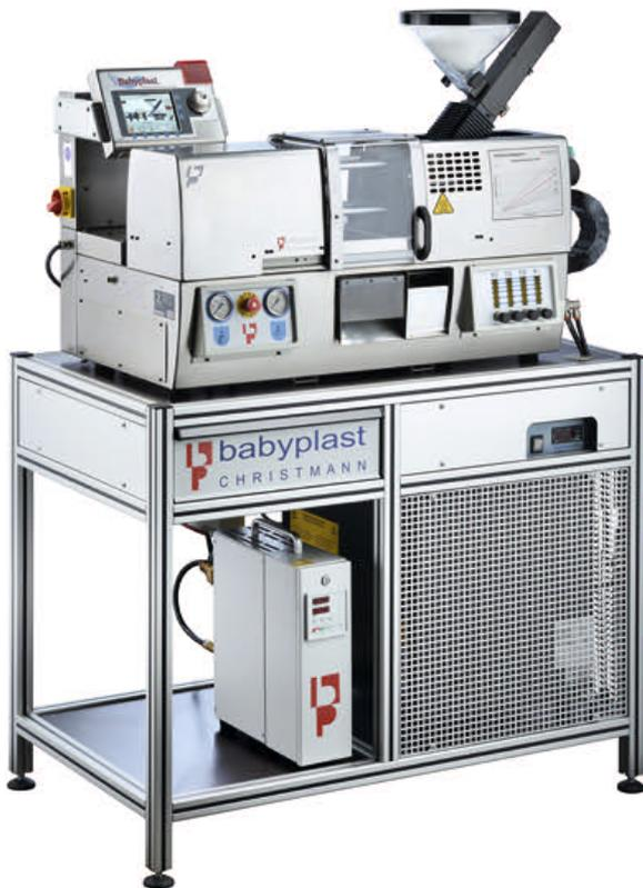
**Die Mikrospritzgießmaschine zeichnet sich durch geringe Investitions- und Betriebskosten sowie eine angussarme Produktion aus**
