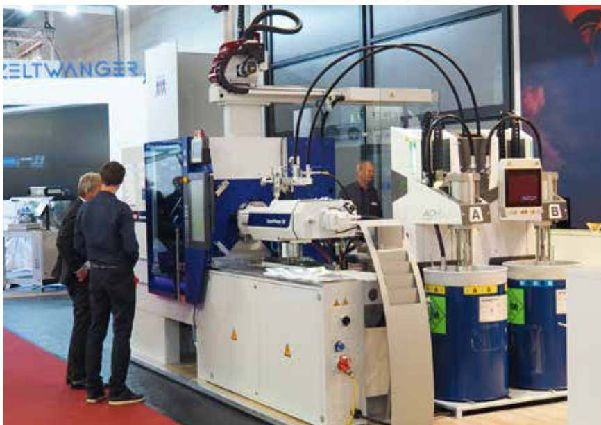
Bild 2. Die von Wittmann Battenfeld entwickelte Produktionszelle vereint eine servohydraulische Spritzgießmaschine SmartPower 90/350 sowie die Pumpe und Mischeinheit von ACH solution auf einer kompakten Stellfläche (© Hanser/F. Gründel)
